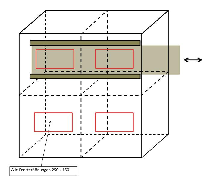
Optional kann eine Fensterreihe mit einem Brett verschiebbar verschlossen werden. Dieses Brett wird durch zwei Leisten geführt und durch Schrauben gegen Herausfallen gesichert. Schnitt siehe rechts.
